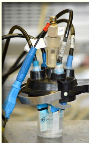
Figura 4: Lengua electrónica diseñada por el grupo de Electroanálisis, constituida por cuatro electrodos serigrafiados modificados.
