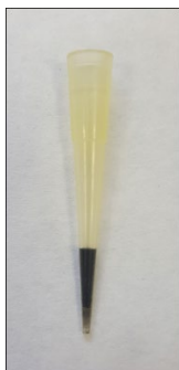
Figura 3. Unidad de microextracción desarrollada sintetizando un monolito de nanocuernos de carbono en el interior de la punta de pipeta.
