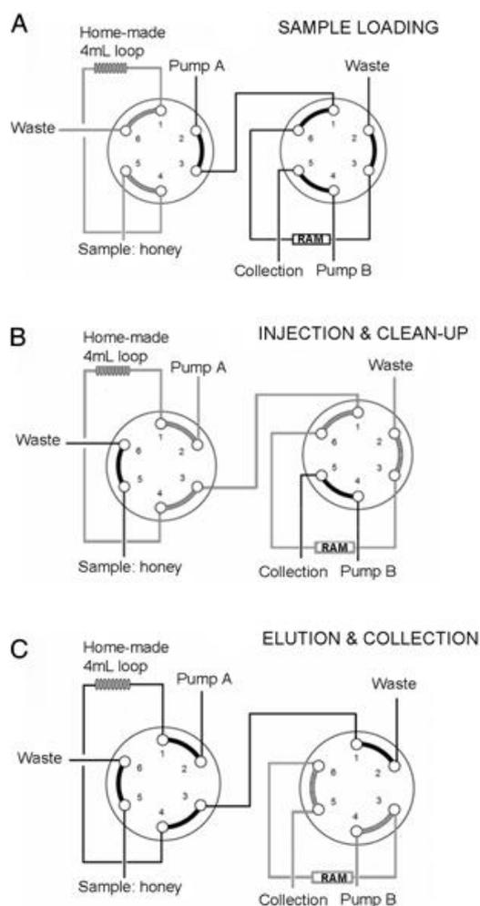
Figura 1. Sistema *on-line*, compatible con CE-MS, para el tratamiento de miel en el análisis de fenoles mediante materiales de acceso restringido (RAM)<sup>3</sup>.
